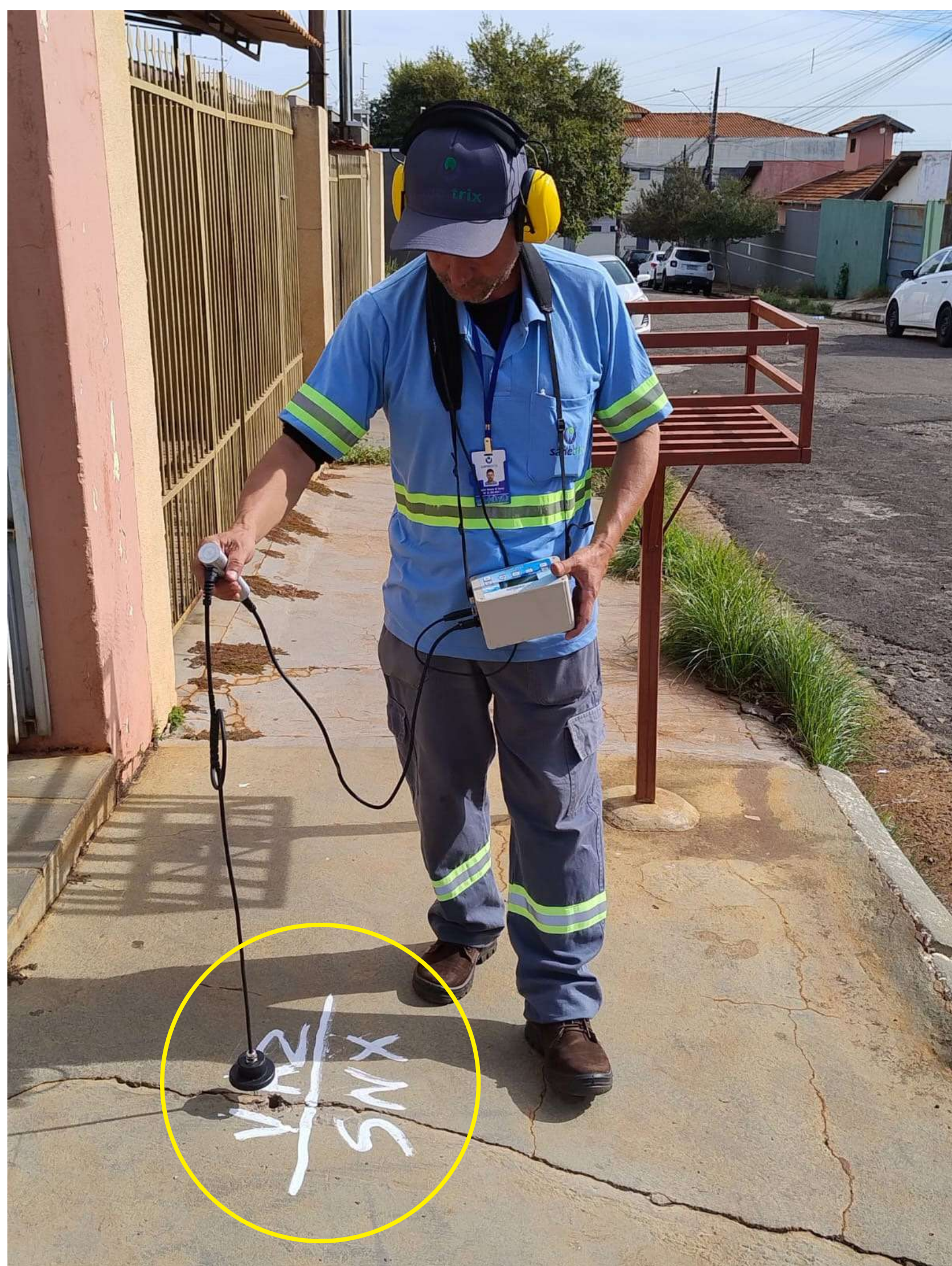
O serviço conta com equipamentos específicos, como geofones e hastes de escuta, que permitem a pesquisa precisa de vazamentos ocultos
